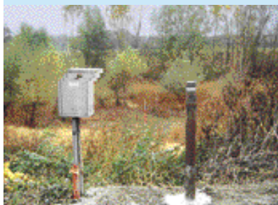
Trois systèmes de suivi des niveaux d'eau : échelle limnimétrique (en arrière plan), piézomètre (droite), piézomètre équipé d'un enregistreur (gauche)
