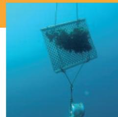
> Moules et échantillonneur passif immergés
