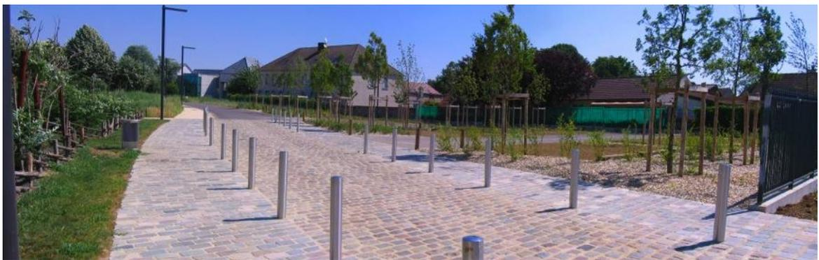
Plateau traversant en pavés du Roi de récupération brut sur voirie et sciés sur trottoir
