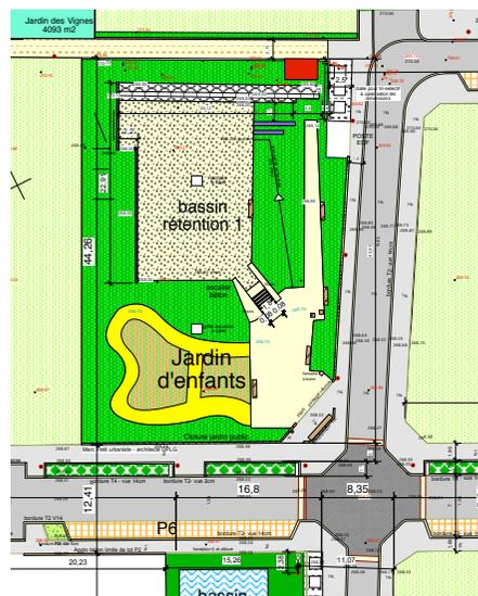
LE BASSIN DE RETENTION EST CONÇU COMME ESPACE VERT, JARDIN D'ENFANT, LE SOL, BALLAST DE 1M DE HAUT PERMET DE PROTÉGER LES OUVRAGES ET RETENIR L'EAU PLUVIALE LES AMÉNAGEMENT SUR L'ENSEMBLE DU LOTISSEMENT SONT DÉCLINÉS POUR QUE L'EAU EMPRUNTE LE CHEMIN LE PLUS LONG AVANT DE SE RE-JETER DANS LE RÉSEAU PUBLIC
