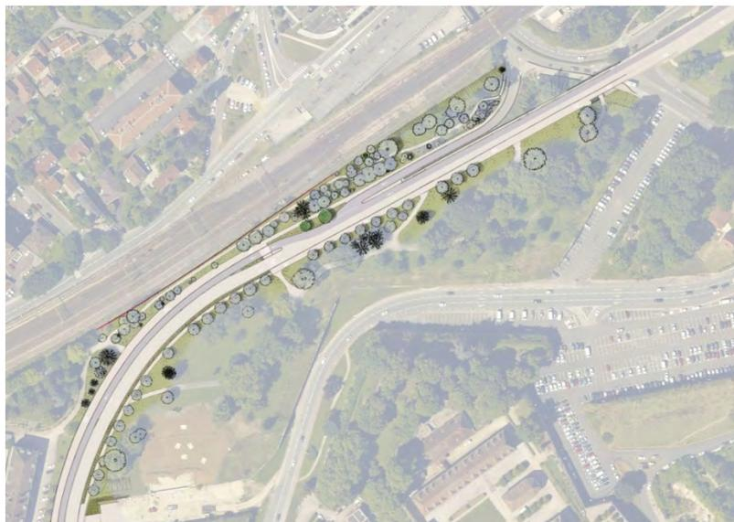
78 500 m<sup>3</sup> d'eau de pluie sont déconnectés, stockés puis infiltrés lors du réaménagement d'une voie de circulation pour les transports en commun. 6 noues paysagères, 4 bassins d'infiltration à ciel ouvert, et 6 bassins d'infiltration enterrés sous des stations de bus sont construits le long de cette voie.
