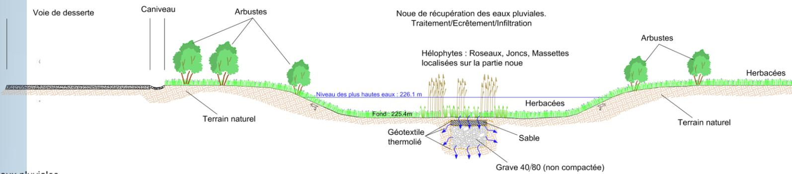
la NOUE PLANTÉE et l'AXE VERT - SCHÉMAS DE PRINCIPE
