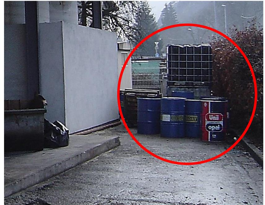
Constat lors de la visite : Local « déchets » occupé par une machine à laver les pièces ; fûts d'huile usagée à l'extérieur en dehors de la dalle de rétention subventionnée...
