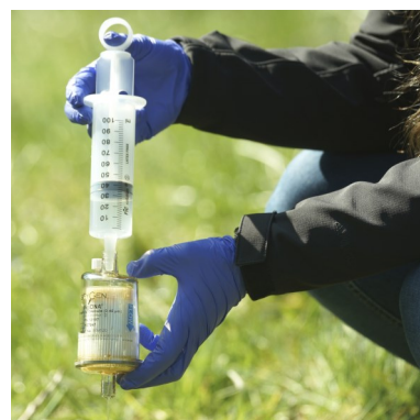
Capsule de filtration stérile pour fixation d'ADNe © SPYGEN
