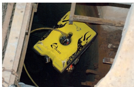
■ Véhicule sous-marin téléguidé plaçant les capteurs.
