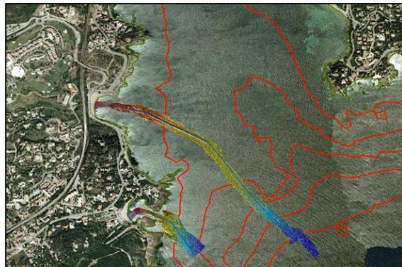
Figure 11 : levé bathymétrique sur les émissaires en rade d'Agay
