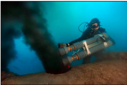
Figure 15 : prélèvement d'eau en sortie d'émissaire
