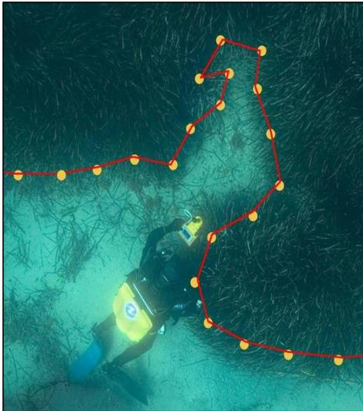
Figure 29 : principe de balisage d'une limite d'herbier par télémétrie
