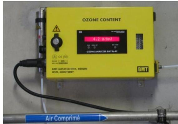
Figure 3 : Photo de l'analyseur d'ozone gazeux (BMT 964 C)
