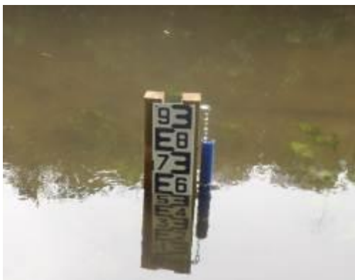
Exemple d'échelle limnimétrique avec mise en place de sonde enregistreuse (photo BURGEAP)
