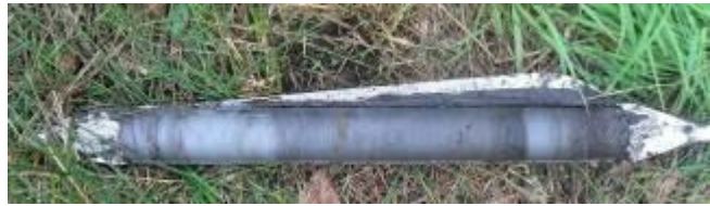
Exemple de sondage au carottier à tourbe (photo BURGEAP)
