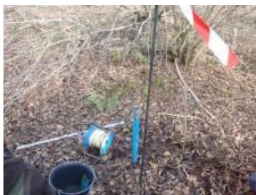
Exemple de piézomètre provisoire mis en place dans un trou de sondage à la tarière (photo BURGEAP)
