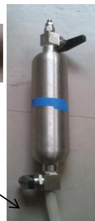
5. Placer les ampoules en **position verticale** (arrivée d'eau en bas). **Tapoter légèrement** l'ampoule pour chasser les bulles d'air éventuellement bloquées. Laisser l'eau circuler **1 à 2 minutes** (5 à 6 fois le volume).
