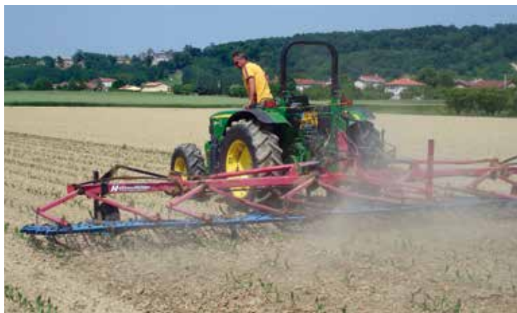
■ Le désherbage mécanique, une alternative aux pesticides.
