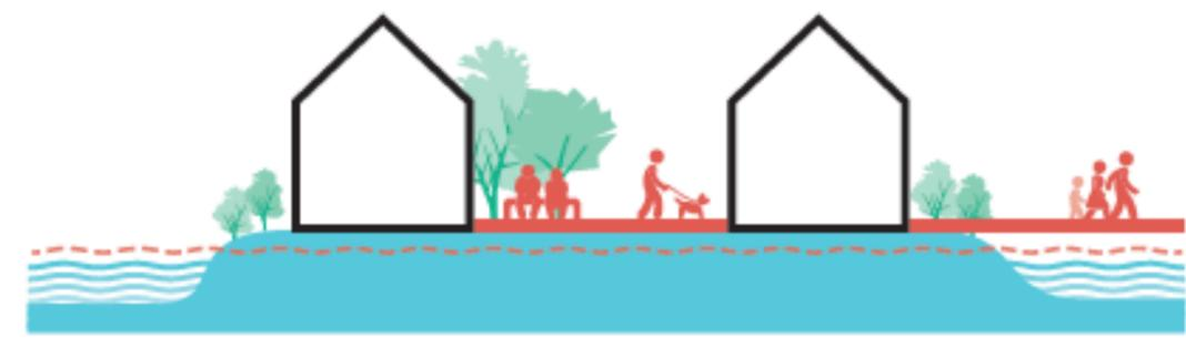
Construction sur socle remblais
