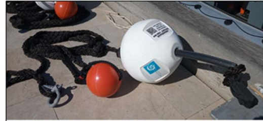
La bouée d'amarrage, la ligne avec sa bouée anti-ragage
