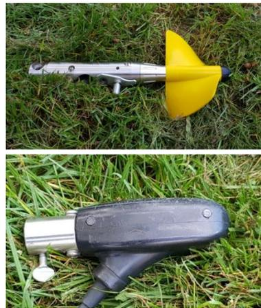
Figure 72 : Hélice d'un micromoulinet (photo du haut) et d'un courantomètre (photo du bas)
