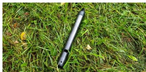
Figure 47 : Exemple d'une sonde CTD avant son installation en rivière
