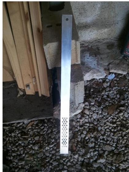
Figure 74 : Fourreau en aluminium (photo de J. Jolivet)
