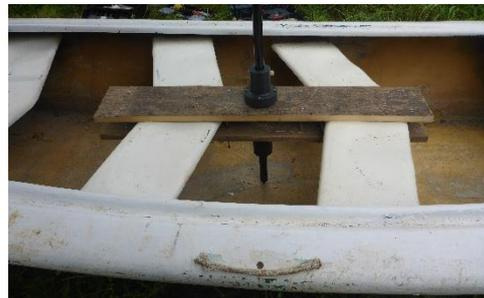
Figure 68 : Socle conçu pour fixer l'antenne du DGPS à un canoë
