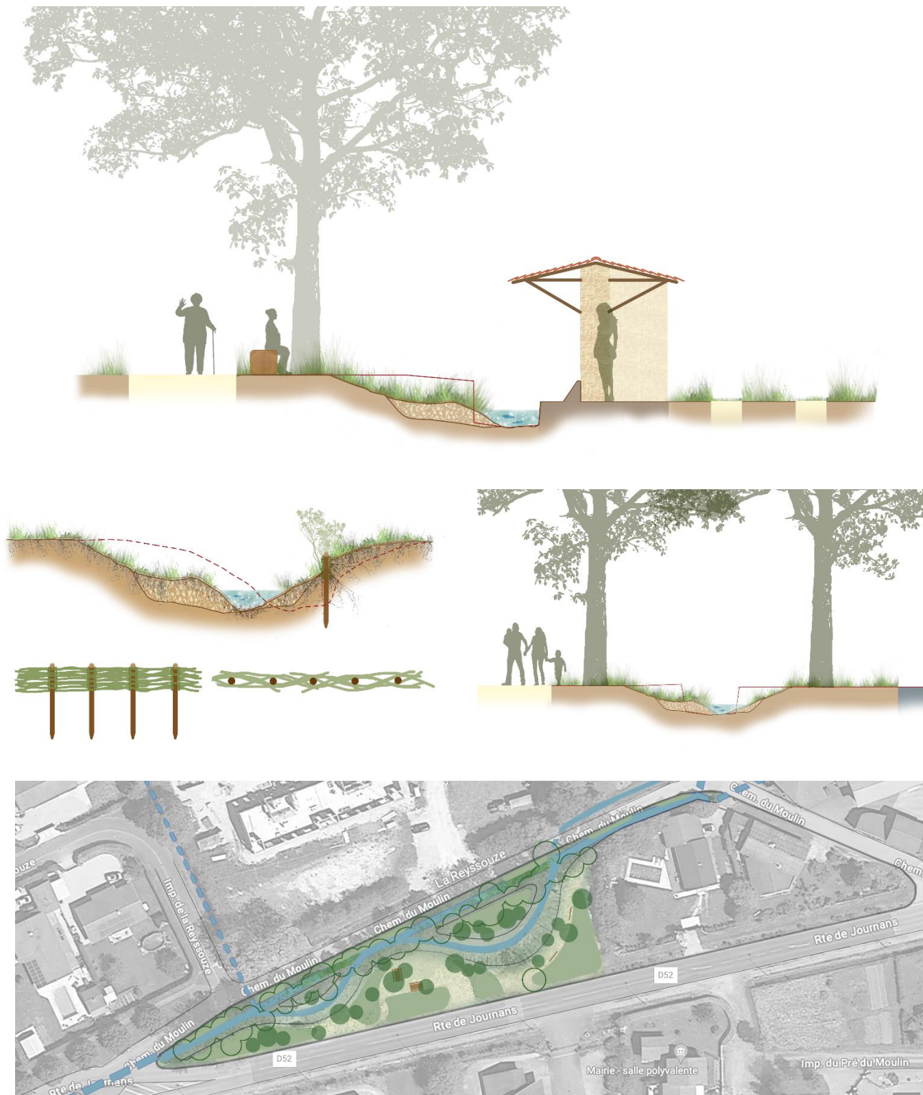
Coupe de principe du reprofilage des berges et de la protection de berges en Fascines / Plan masse du projet
