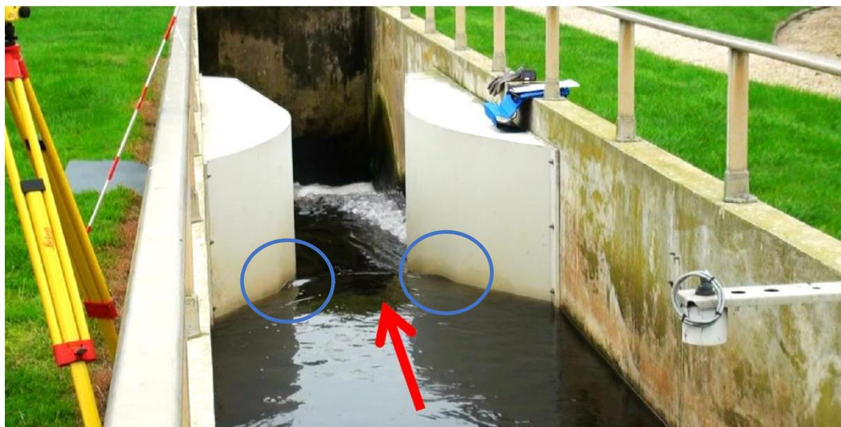
Figure 13. Exemple de déformations non mesurées (entourées en bleu) avec le protocole proposé.
