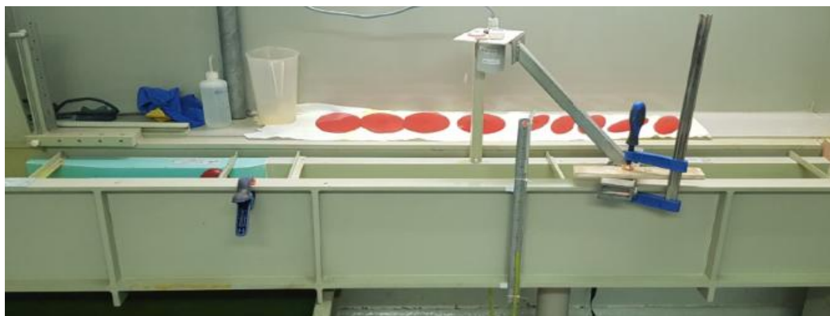
Figure 1. Test d'un canal Venturi avec diverses déformations (source : AERMC).
