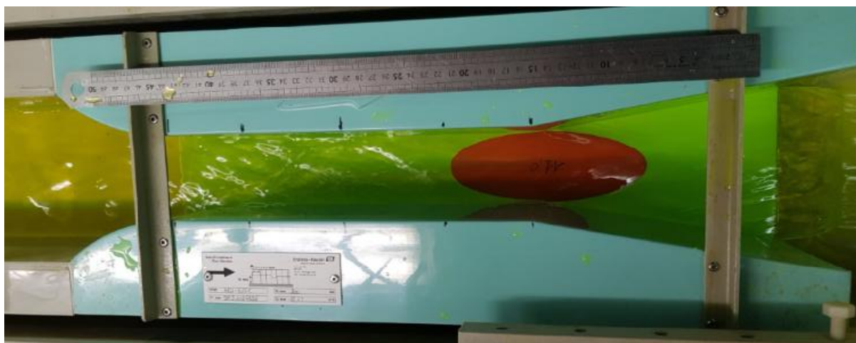
Figure 4. Exemple d'une bosse située sur le radier en aval du col (source : AERMC).
