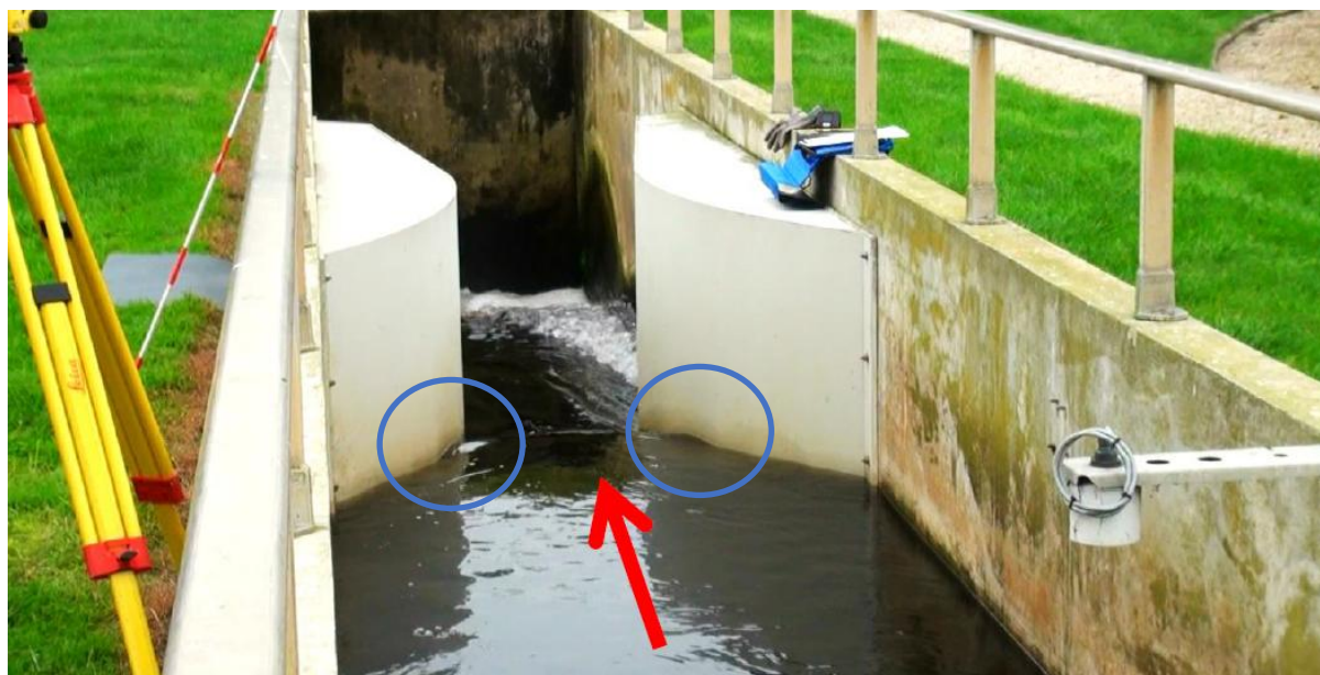
Figure 12. Exemple de déformations non mesurées (entourées en bleu) avec le protocole proposé.
