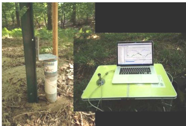
Piézomètre et lecture des données collectées © LUCOT E.
