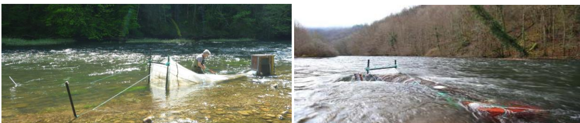
Figure 70 : Illustration de l'installation d'un dispositif de contrôle de la dérive des alevins émergents de poissons (a) et de son comportement au débit d'éclusée (©ECOGEA).
