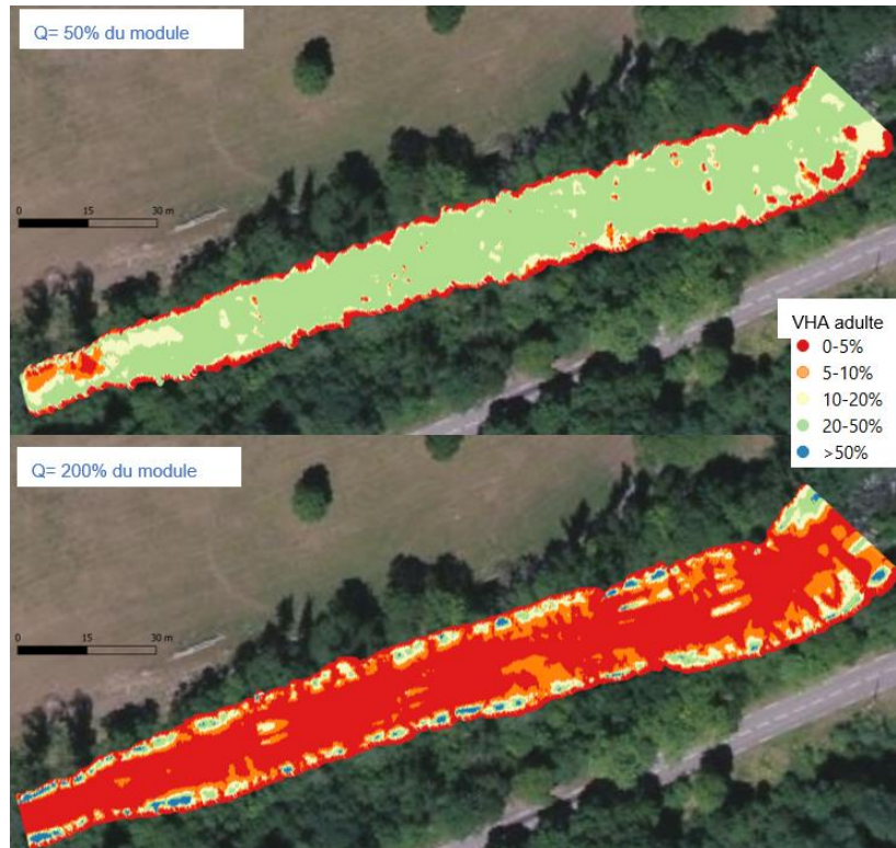
Figure 23 : Cartographies des habitats favorables aux truites adultes (VHA) sur une rivière des Pyrénées, de 7,5 m 3 /s de module et 1,4 % de pente, à 50 % et 200 % du module (données ECOGEA pour EDF-CIH).
