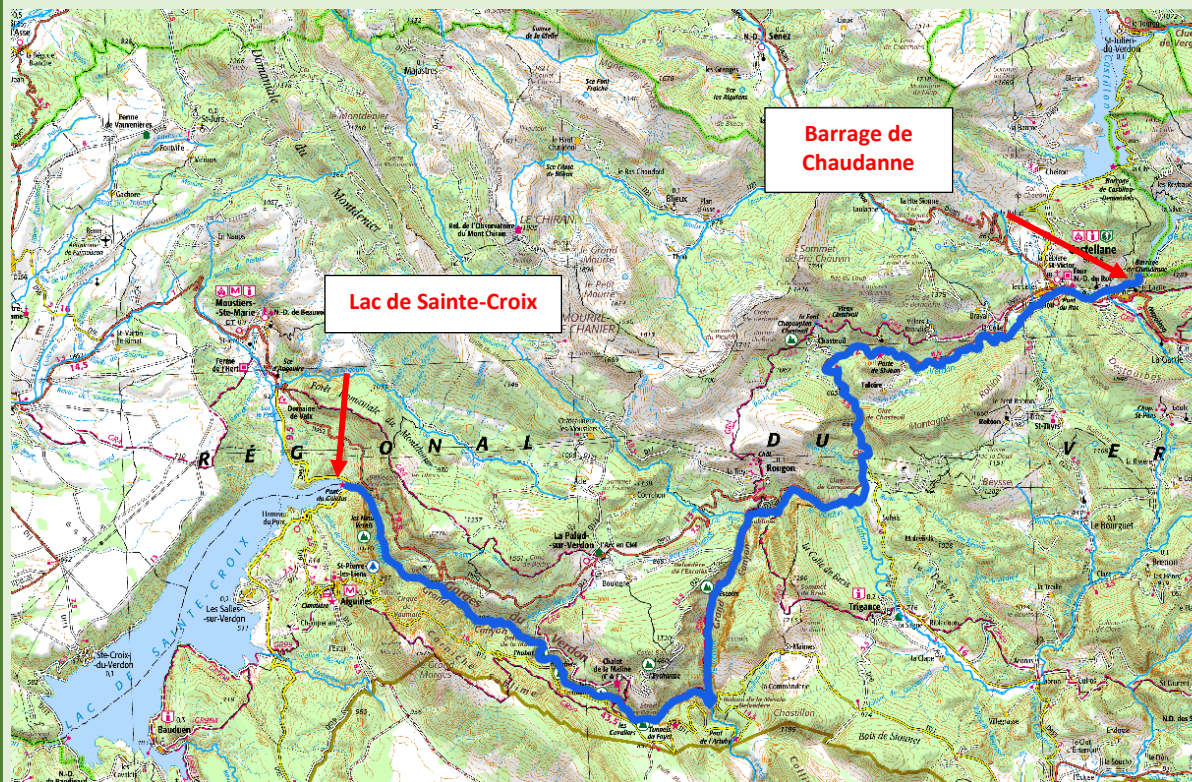
Figure 73 : Le tracé en bleu indique le linéaire impacté par les éclusées entre la retenue de démodulation de Chaudanne, en aval du barrage de Castillon et le lac de Sainte Croix sur le Verdon (soit environ 38 km).
